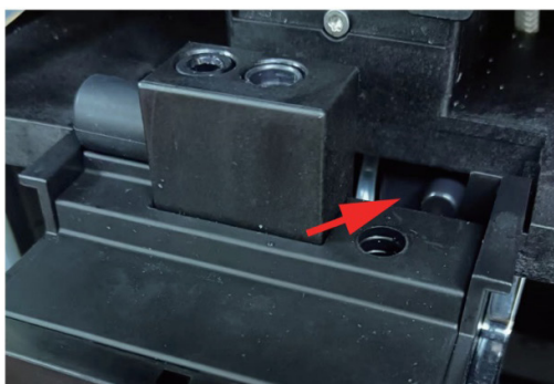
8. Umístěte sirupové hadičky do výdejní pozice a poté zapojte napěňovač mléka zpět do kávovaru.
