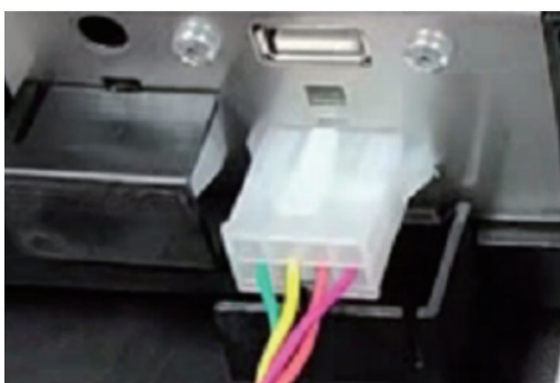
9. Zapojte kabel pro připojení ke kávovaru do zdířky na zadní straně sirupové stanice
