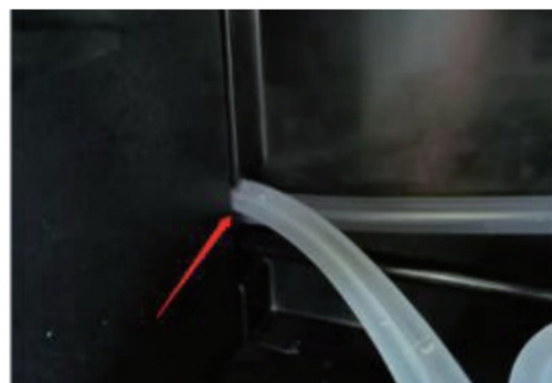
3. Zapojte sirupové hadičky pro připojení ke kávovaru do sirupové stanice. Druhý konec těchto hadiček zasuňte do kávovaru z levé strany.
