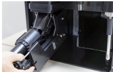
4. Pomalu spusťte spařovací jednotku dolů, nakloňte ji a vytáhněte dopředu. Držte ji pevně.
